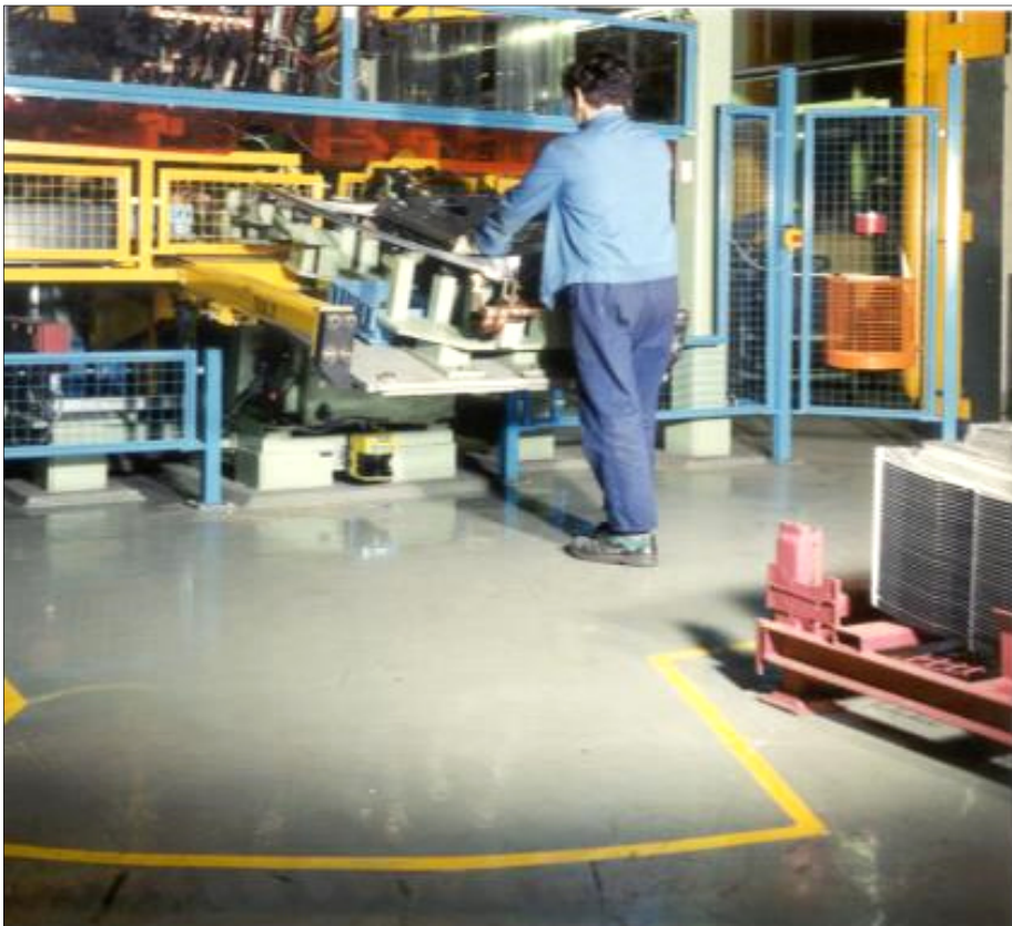
Waagerechte Bereichsabsicherung einer Schweißstation
