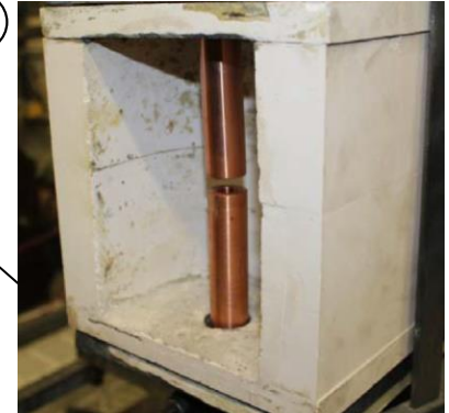
Elektroden-anordnung mit Box gemäß IEC 61482-1-2
