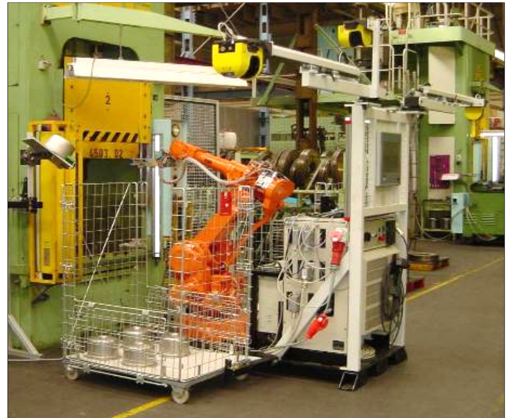
Senkrechte Gefahrstellenabsicherung an einen mobilen Roboter vor einer hydraulischen Presse
